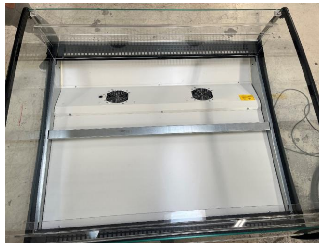
Billede 4: Begge stålplader afmonteret
