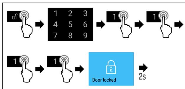
Fig. 75 Locking door using door code 1 1 1 1.
